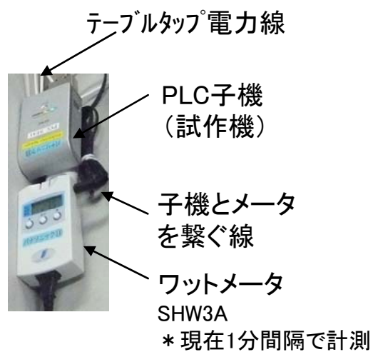
図 5-32. PLC 技術を用いた情報家電機器のモニタリング
