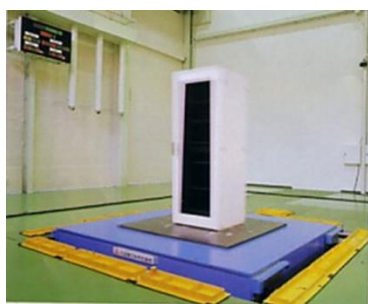
(1) 耐震試験設備 (2) 耐震強度解析イメージ
