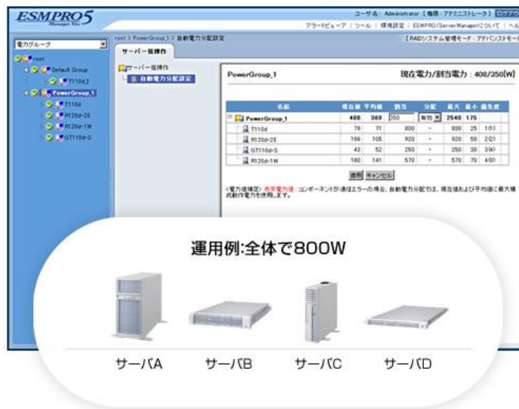
図 2-26 ICT 機器添付の運用管理ソフトウェアのグループ電力ピーク制御運用設定事例
